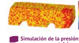
Simulación de la presión sonora en un autobús
